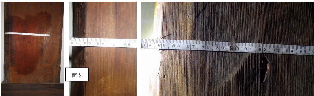
写真1～3 左：4階通柱(北3・東4) 中：測定箇所(左端に面皮) 右：年輪画像の拡大(左端に辺材)
